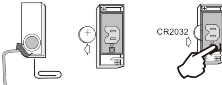
Ouvrez d'abord le couvercle à l'aide du clip fourni, puis faites glisser la batterie hors du compartiment. Appuyez ensuite sur le bouton de test de manière continue et repoussez en même temps la pile dans le compartiment, continuez à appuyer sur le bouton pendant cinq secondes jusqu'à ce que la LED clignote cinq fois. Un nouveau code a maintenant été généré.
